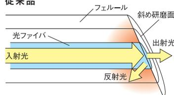
斜め研磨面で反射光を反らすことで、送信側への戻り光を低減させます。反射光による発熱が、終端部のみに集中します。
