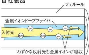
入射光・反射光を共に吸収する、金属イオンドープファイバを使用して、送信側への戻り光を低減させます。ファイバ全体で低減しますので、終端部での発熱を抑えられます。
